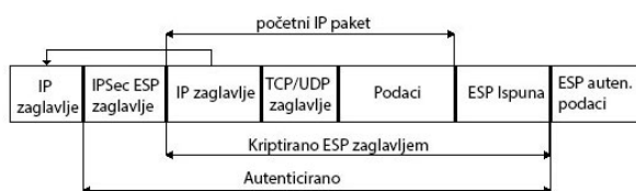
Slika 2. Prikaz paketa enkapsuliranog u transport načinu
