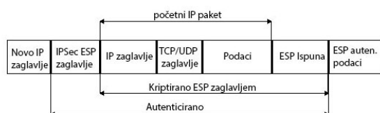
Slika 3. Prikaz paketa enkapsuliranog u tunel načinu
