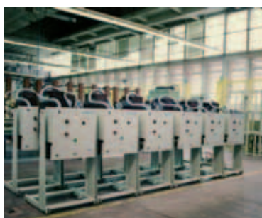
Slika 12 Vakuumski prekidači serije V 38 (kV); 1250 (A) „Končar“ -jednopolni za HŽ
