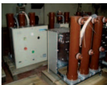
Slika 11 Vakuumski prekidači serije VK 24 (kV); 800 (A) „Končar“
