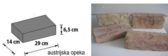
Slika 1 Dimenzije pune austrijske opeke iz ciglane Augusta Brauna [5]
