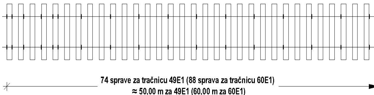
Slika 10 MATHE sprave protiv uzdužnog putovanja tračnica [13]
