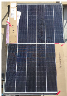
Slika 9 2 nd scenarij – Zasjenjenje u gornjoj polovici FN modula Figure 9 2 nd scenario – Shading in top part of the PV module
