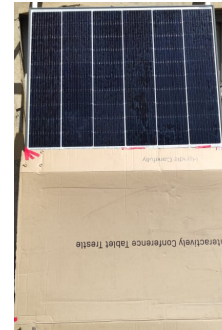
Slika 11 4 th scenarij – Vertikalna sjena Figure 11 4 th scenario – Vertical shade
