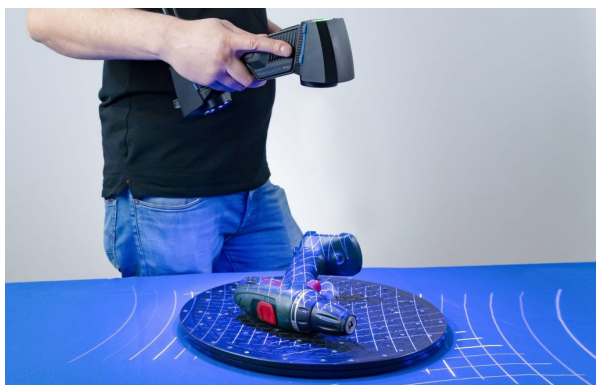
Slika 2 Prikaz korištenja strukturiranog svjetlosnog skenera
