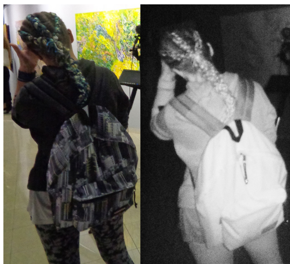
Slika 1 Odjevni predmeti u okolini promatrani golim okom u vizualnom spektru (lijevo) i promatrani pomoću infracrvene kamere u NiR spektru (desno)
