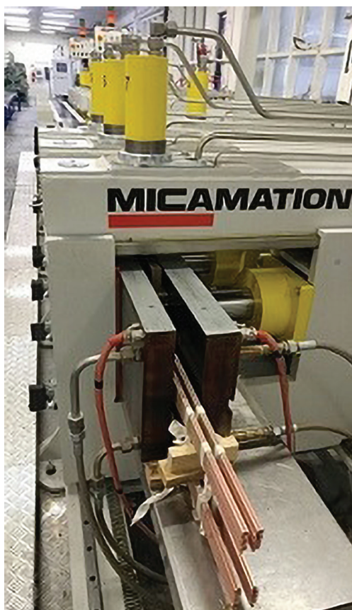
Slika 6 Predprešanje statorskog namota
