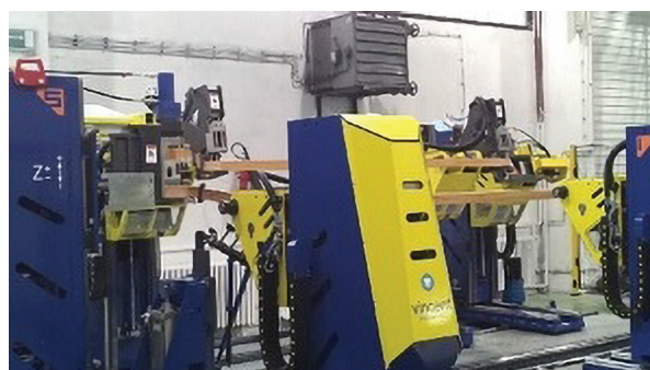
Slika 7 Formiranje statorskog namota
