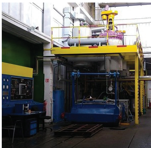
Slika 9 Komora za vakuumsko-tlačnu impregnaciju
